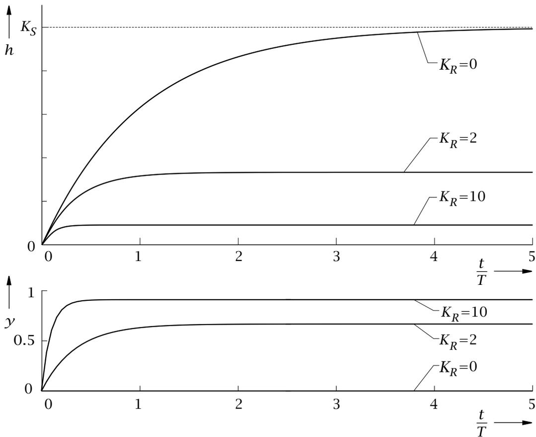
Bild 5-2: Störübergangsfunktionen und dazugehörige Stellgrößenverläufe des Regelkreises nach Bild 5-1
